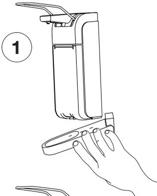
**D** Es kann eine Abtropfschale am Spender angebracht werden. Verbinden Sie diese mit dem Spender, indem Sie diese von hinten einschieben.
