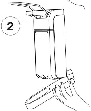
**D** Klappen Sie die Abtropfschale bei Bedarf durch Druckausübung herunter.
